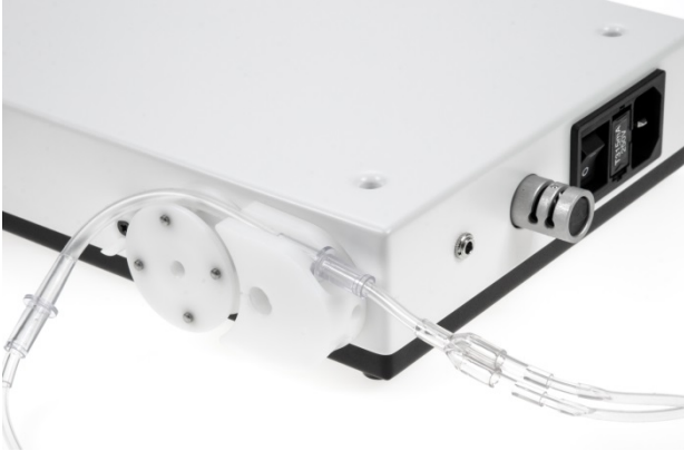
Figur 5 Udpak slangesættet, og anbring slangen som vist
