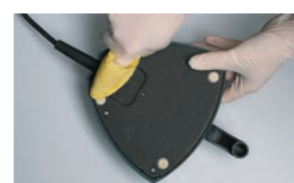
Pulire periodicamente i piedini in gomma sotto il pedale XO con della benzina.
