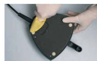
Reinigen Sie die GummifüÙe unter dem Fussanlasser regelmäßig mit Reinigungsbenzin.
