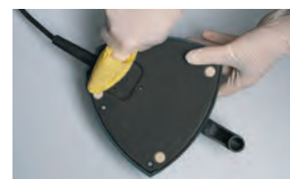
Καθαρίζετε τις πλαστικές βάσεις του ΧΟ Ποδοδιακόπτη συχνά με βενζίνη
