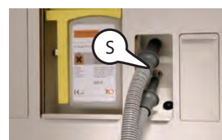
Afzuigslangen bevestigd aan nippels ter desinfectie
