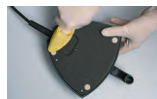
Schoonmaken van rubberen dopjes onder het XO voetpedaal met wasbenzine
