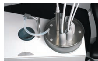
Desinfektion des Wassersystems
