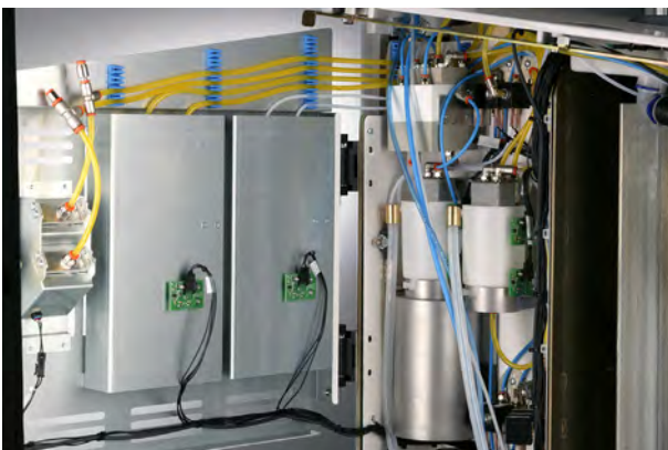
Imagen 27 Acceso al separador de amalgama
