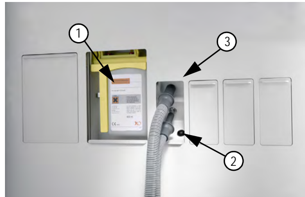
Figure 17 Rinçage du système d'aspiration
