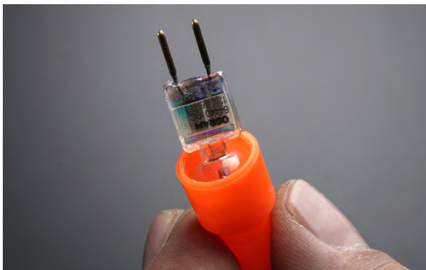
Figure 32 Remplacement de l'ampoule de la lampe
